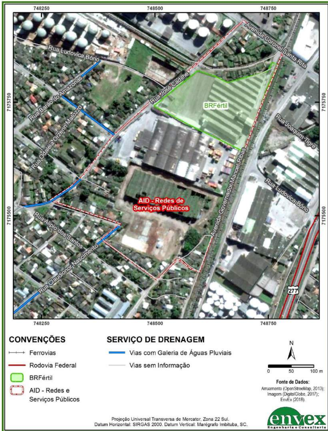
Figura 46: Parte da rede de drenagem pluvial cadastrada na AID de Redes de Serviços Públicos.
