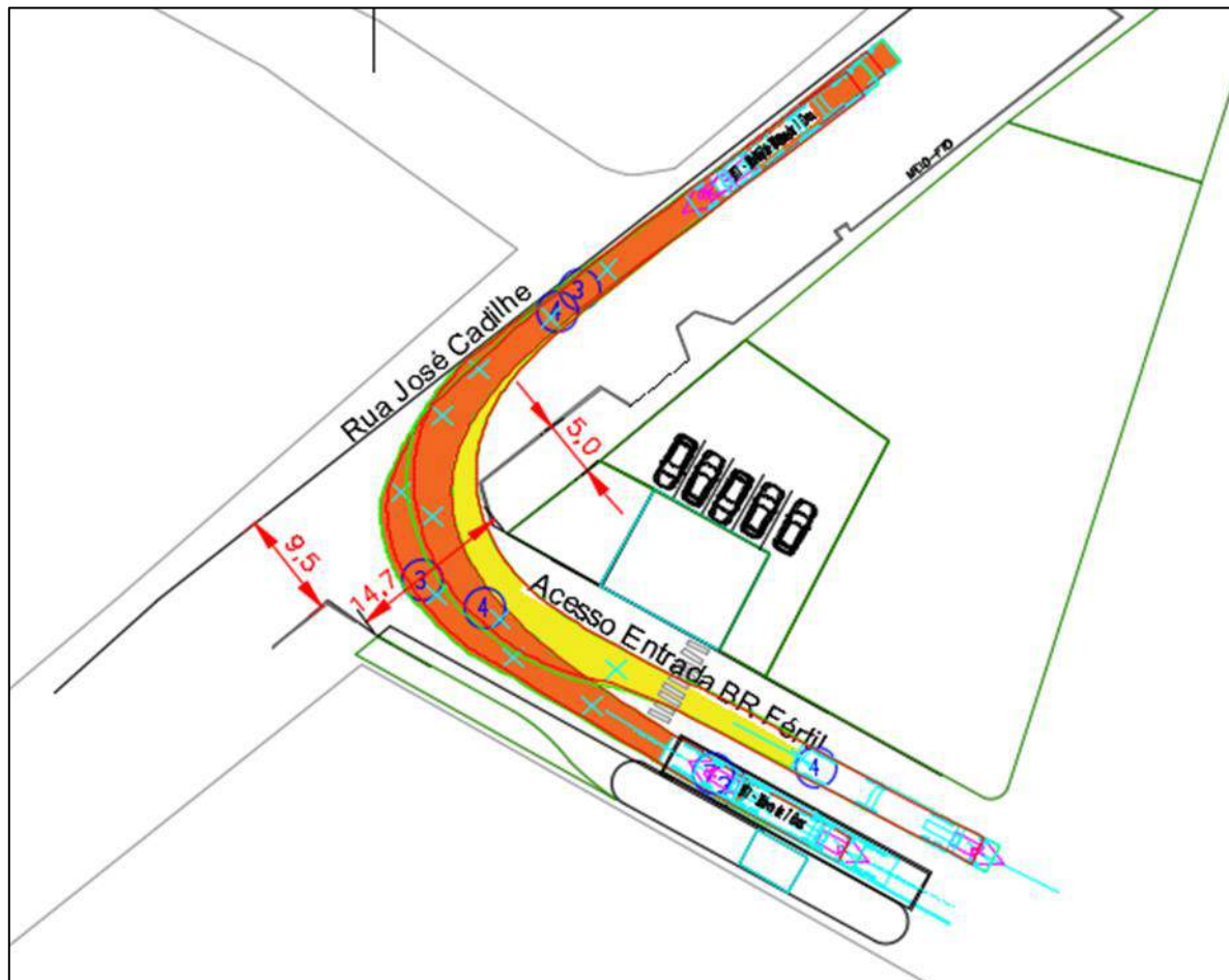
Figura 73: Estudo do raio de giro no Ponto 4, na entrada do empreendimento, na R. José Cadilhe.
