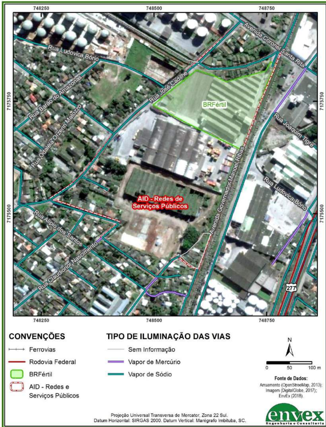
Figura 47: Rede de iluminação nas vias públicas na AID de Redes de Serviços Públicos, classificada por tipo de iluminação.
